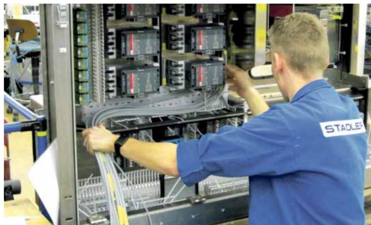
Renforcement du système de formation duale: Automaticien de 4ème année lors du cablage d'une armoire de commande 400V pour un véhicule ferroviaire du trafic régional.
